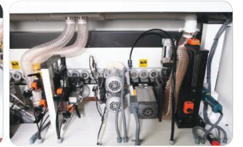
FREZELEME, TEMİZLEME, POLİSAJ, KANAL AÇMA, SICAK ÜFLEME MILLING, CLEANING, BRUSHING, CHANNEL DRAWER, HOT AIR
