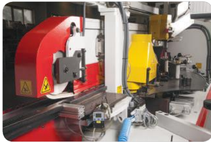
KAYIŞLI ÜST BASKI SİSTEMİ AUTOMATIC TOP PRESS WITH BELT SYSTEM
