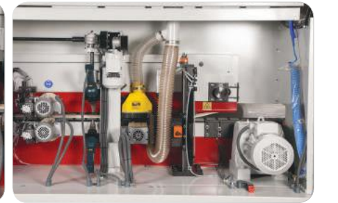
SICAK HAVA ÜFLEME, JAMPINGLI VE ÜNİVERSAL KANAL AÇMA HOT AIR BLOWER AND GROOVING UNIT WITH JUMPING SYSTEM
