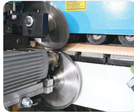
KAYIŞLI ÜST BASKI SİSTEMİ AUTOMATIC TOP PRESS WITH BELT SYSTEM
